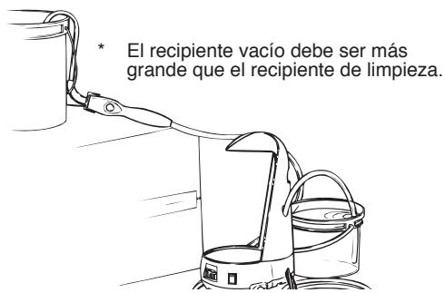
2. Gire el regulador de velocidad a 9. presione completamente y suelte el botón del mango y deje correr como mínimo un galón de agua jabonosa tibia por la unidad (el tiempo de limpieza varía según el tipo de pintura utilizada).
