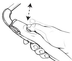
4. Retire la protección contra salpicaduras. Presione la lengüeta de bloqueo (a) y caiga el montaje del conjunto del rodillo en un cubo de la solución apropiada de la limpieza.
